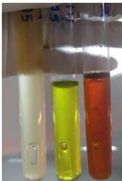
Figura 2 – Testes para coliformes totais e termotolerantes positivos (à direita Caldo Lauril Triptose, ao centro Caldo Verde Brilhante Bile a 2% e à esquerda Caldo E. coli ).
