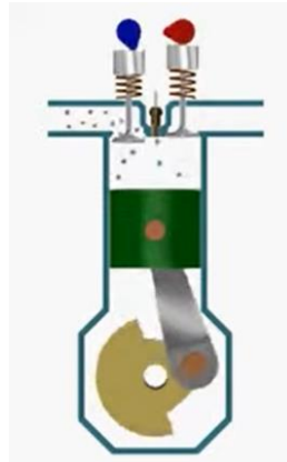
Figura 2 – Ilustração do sistema biela manivela
