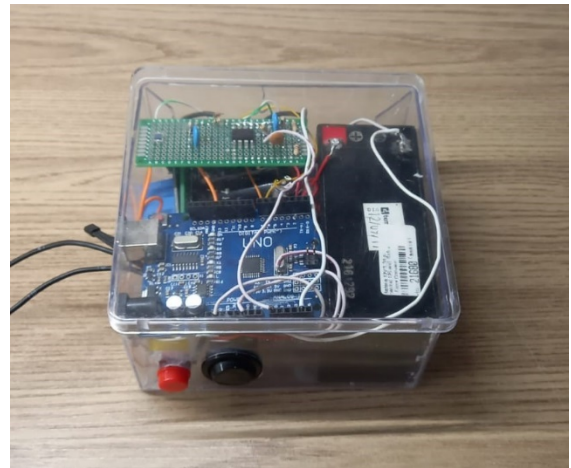
Figura 12 - Montagem do protótipo do traçador de curvas I-V. Fonte: Autores.
