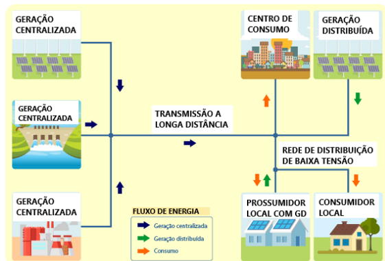
Figura 1 - Conexão de geração distribuída à rede. Adaptado de CANAL SOLAR (2021), acesso disponível em 13/05/2021, às 11h40.
