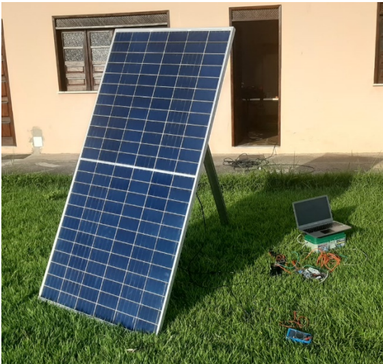
Figura 14 - Módulo FV utilizado para a aquisição dos dados. Fonte: Autores.
