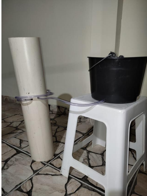
Figura 11. Corpo da torre é o cano de PVC com 150mm de diâmetro, tubulação a mangueira de silicone que sai do reservatório para o corpo da torre e reservatório de água quente do protótipo da torre foi utilizado um balde preto de 20 litros.
