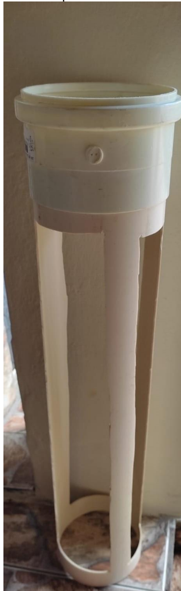
Figura 10. Base do protótipo da torre de arrefecimento, a parte superior é a luva que uniu a base com o corpo da torre, a base aberta serve para a entrada de ar frio na parte inferior da torre.
