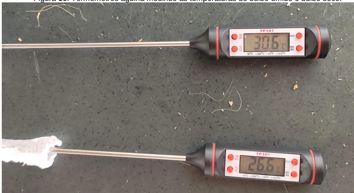
Figura 16. Termômetros agulha medindo as temperaturas de bulbo úmido e bulbo seco.
