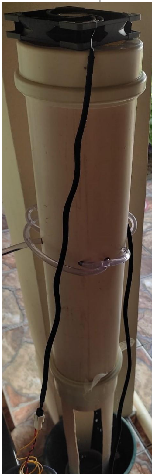
Figura 15. Protótipo da torre de arrefecimento, o exaustor está na parte mais superior da torre conectado ao tampão que faz a conexão com o corpo da torre, onde fica a tubulação e o preenchimento e a luva faz a conexão do corpo com a base da torre.
