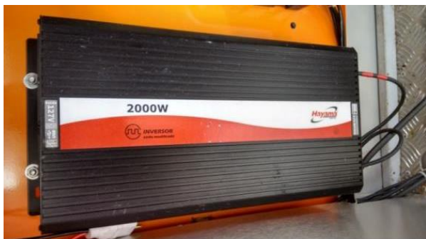
Figura 6. Inversor 2000WHayama Ent:12v Saída:127v. Fonte: Zamperim, 2017.
