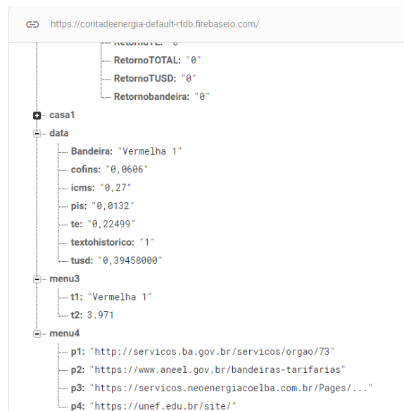
Figura 9: Dados armazenados no Realtime Database . Fonte: O Próprio Autor.
